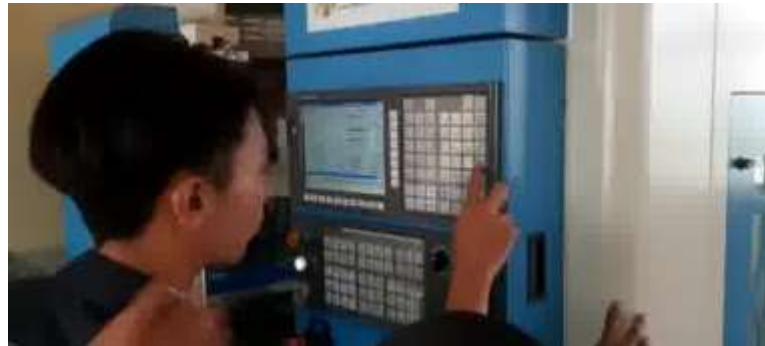
Gambar 3. Melakukan setting awal mesin CNC milling
